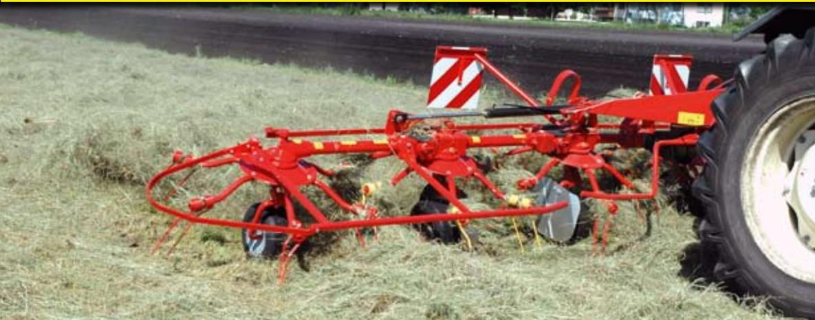
Die Zetter Baureihe in MODUL-Bauweise ist ausgelegt für den Einsatz in Großbetrieben und bei Lohnunternehmern. Mit je zwei Modellen mit 6 und 8 Rotoren wird der Arbeitsbereich von 6,70 m bis 10,50 m abgedeckt.
