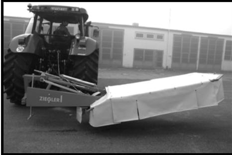
Abbildung 15: Seitlich abgesenkt (Vorgewendestellung)
