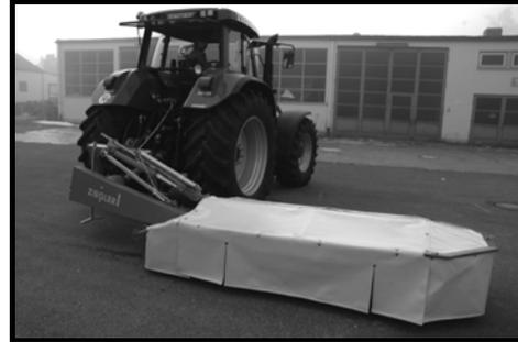
Abbildung 16: Seitlich abgesenkt (Mähstellung)
