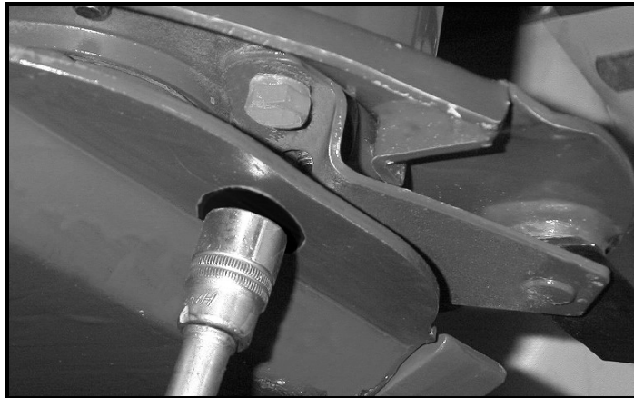
Abbildung 36; Messerhalterwechsel an der Antriebs-Mähscheibe
