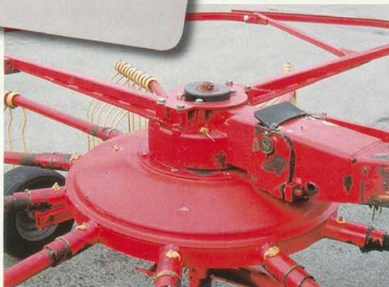
*Das Getriebe der Kreisel wurde bei einigen Schwadern bereits ersetzt.*
