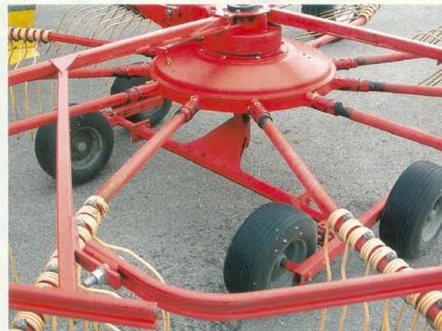
Das Tandemfahrwerk sorgt für eine gute Boden Anpassung.
