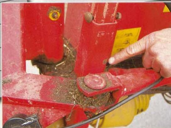
Beim Wenden nach links kann das Führungsrohr der Abstellstütze eingedrückt werden.
