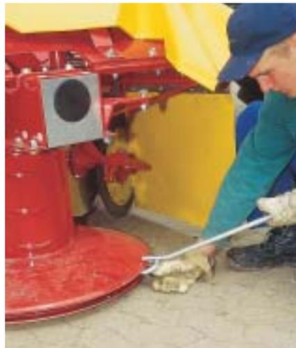
Dank Schnellwechsel-System gelingt der Klingenwechsel flott. Drehen oder Wechsel steht je nach Boden und Futter nach 25 bis 35 ha an.
