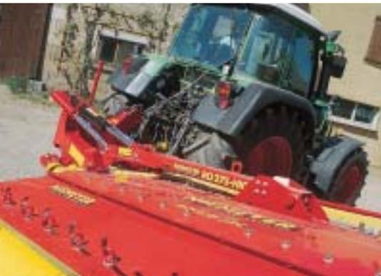
Die Mittenaufhängung sorgt für gute Boden-anpassung, mit Grenzen an Böschun-gen. An- und Abhängen geht leicht.
