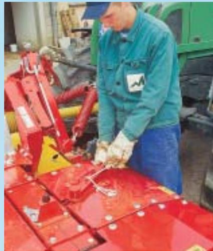
Durch Umstecken kann man die Schwadbreite ohne Werkzeug an den vorgespannten Traktor anpassen. Beim ...
