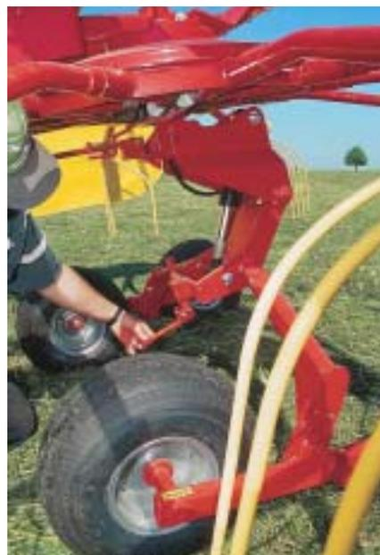
Per Spindel lässt sich die Rechhöhe einfach einstellen, man muss aber unter die Kreisel greifen. Die Kurvenbahn ist unten offen.
