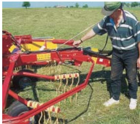
Damit der vordere Kreisel je nach Traktor waagrecht arbeiten kann, wird die Deichsel per Drehspindel justiert.
