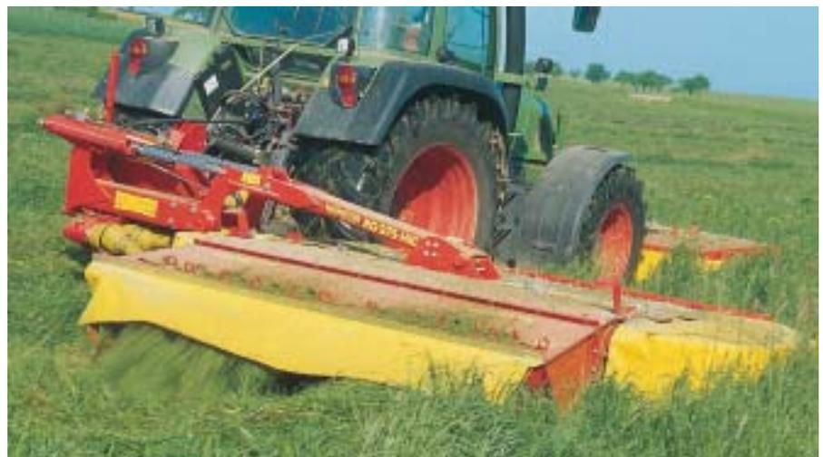
Die Mittenaufhängung sorgt für gute Boden-anpassung. Die Verstopfungs-gefahr ist sehr gering. Mit 1285 kg ist das RO 275-HIC kein Leichtgewicht. 500 kg Frontballast im Solo-einsatz oder ein zweiter Mäher vorne sind beim 100 PS Vierzylinder-Traktor sinnvoll.
