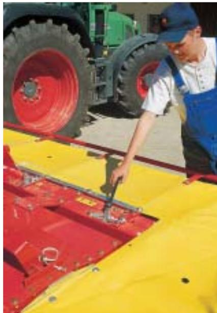
Typisch Trommelmäher: Über die vier einzelnen Spindeln wird die Mähhöhe verändert. Das kostet Zeit.
