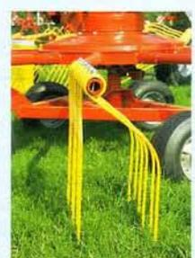
Transport in der Mitte hydraulisch abgesenkt. Zinkenarme brauchen nicht abgebaut zu werden. Die Transporthöhe liegt bei 3,93 m.
