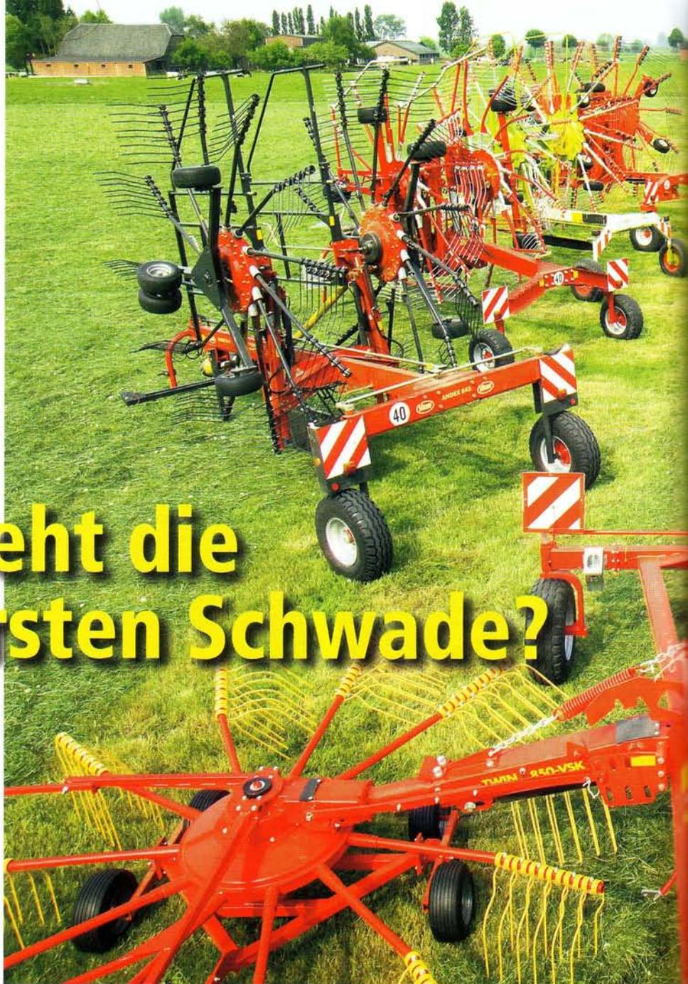
**Z**weikreisell-Mittelschwader sind eine Alternative zu den leistungsfähigen Seitenschwadern, wenn die Silage mit der Rundballenpresse oder dem Ladewagen geborgen wird. Neun Mittelschwader in der Klasse von 7,30 bis 8,80 m Arbeitsbreite haben wir gemeinsam mit dem holländischen Magazin *Boerderij* auf Haus Riswick verglichen. Die namhaften Hersteller waren vertreten.
