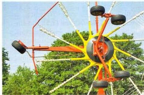
Der Schwader kann mit dem zusätzlichen Multitrad ausgestattet werden, um die Boden-anpassung zu verbessern.
