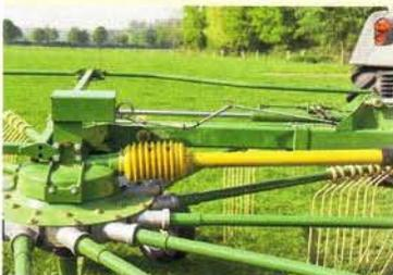
effekt ist Bodenanpassung nach hinten allerdings eingeschränkt ( $\pm 5$  Grad). Teilweise bleibt Futter in Senken liegen. Trotz der höheren Räderzahl ist die Bodenanpassung nicht besser. Die hinteren Räder können bei engen Kurvenfahrten radieren.
