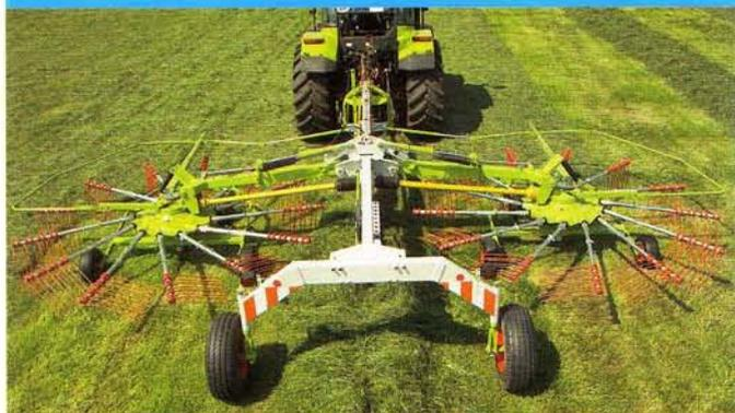
Claas hatte die geringsten Verluste, legte das Schwad (12 km/h) aber schlechter ab, weil mit hoher Drehzahl gefahren wurde.
